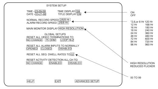
\* 2/6/8 HR FOR NTSC/EIA MODEL MULTIPLEXERS, 3 HR FOR PAL/ CCIR MODELS. REMAINING RECORD SPEEDS DEPEND UPON VCR MODEL.
